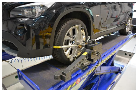
Stabile Schiebeuntersätze mit schwenkbar/ schiebbarer oberer Platte zum verspannungs-freien Vermessen/ Einstellen der Hinterräder.
