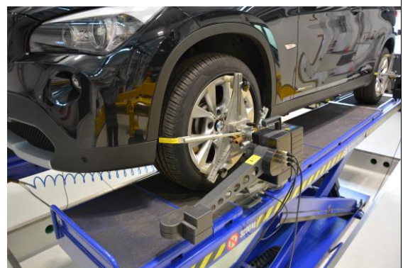
Stabile Schieberunterstützen mit schwenkbar/ schiebbarer oberer Platte zum verspannungs-freien Vermessen/ Einstellen der Hinterräder.
